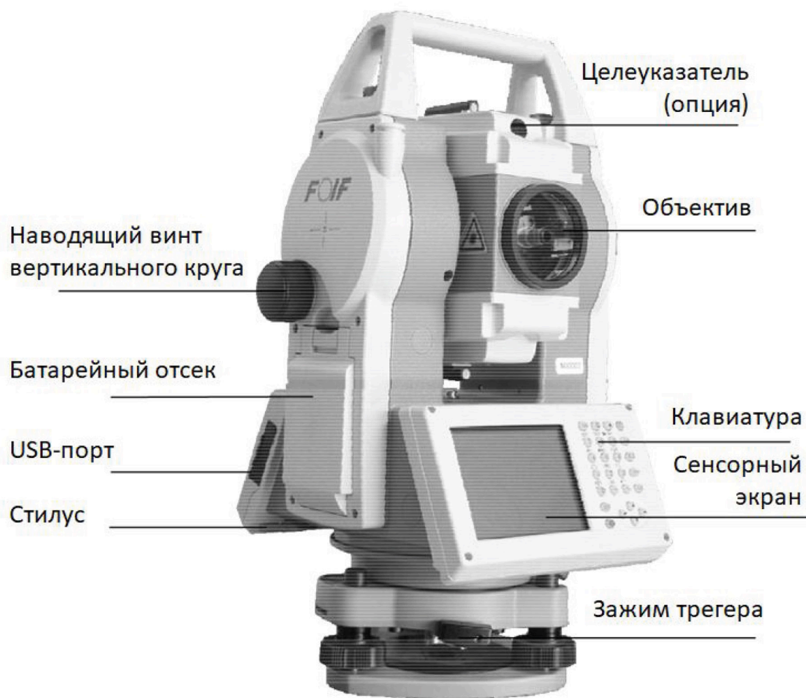
Рисунок 3 - Основные элементы тахеометра RTS362
