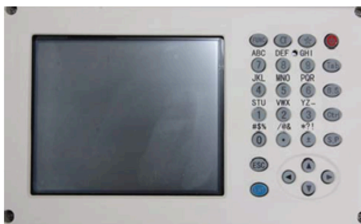
Рисунок 4 – Экран и клавиатура тахеометра RTS362
