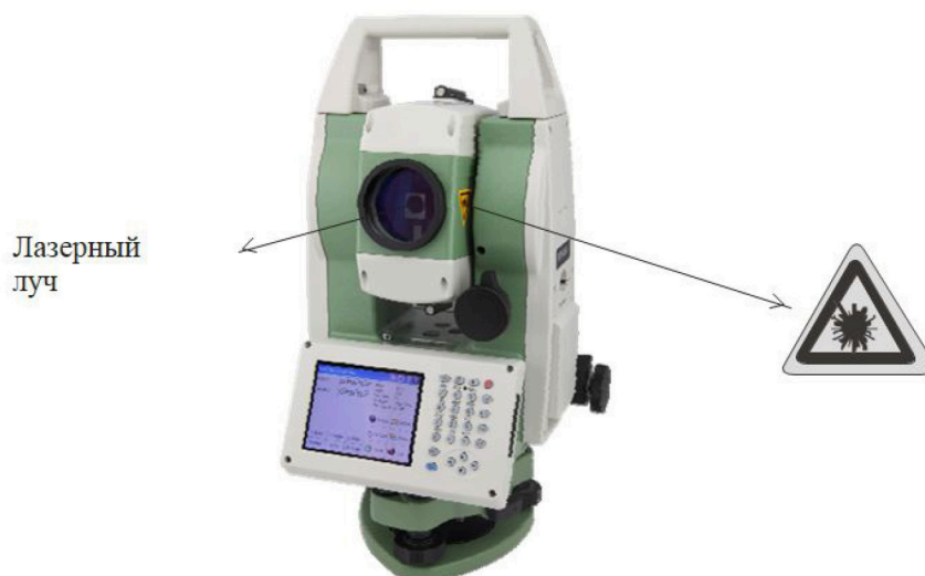
Рисунок 1 – Наклейки с оповещением об опасности лазерного излучения
